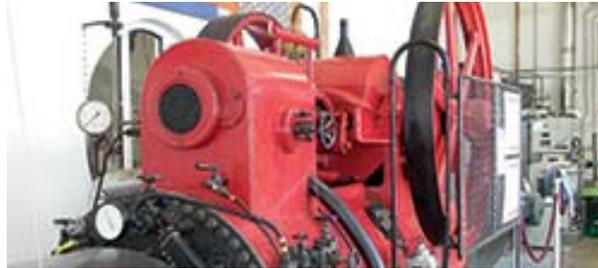
Bei uns sehen Sie eine Dampfmaschine aus dem Jahr 1937, die in den früheren Jahren die Energie in Form von elektrischem Strom und Wärme für die Sägewerke lieferte. Sie wird mit Holzresten befeuert, die in unserem Sägewerk anfallen. Über einen Flachriemen wird der Generator angetrieben, der früher den Strom für das Sägegatter erzeugte. Ein kurzer Film in hinteren Teil des Raumes zeigt Ihnen die Maschine in Funktion.
